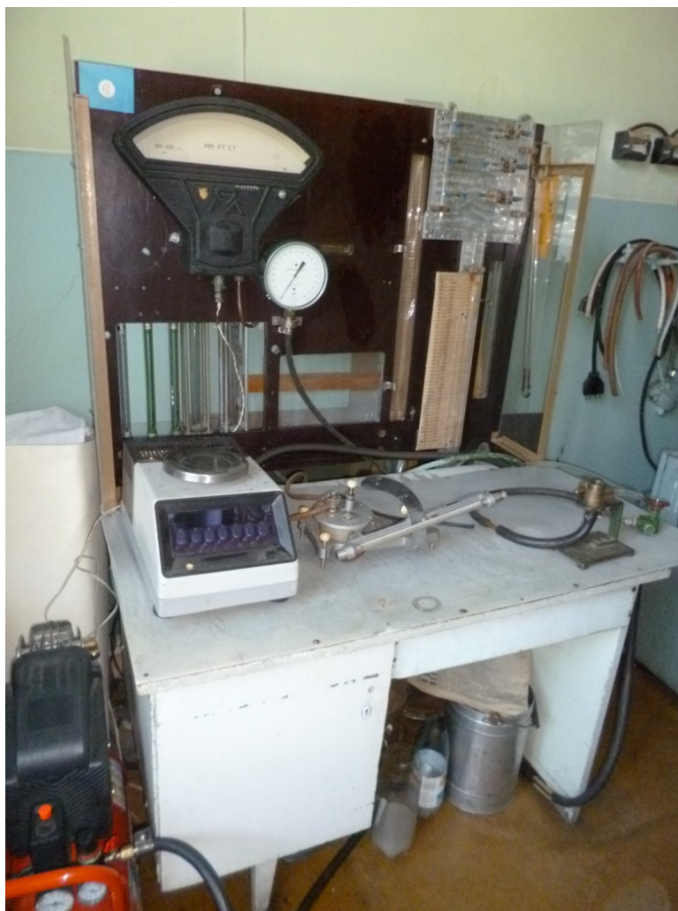
Рис 3. Експериментальний стенд ІПМ НАН України, призначений для досліджень газової проникності металевих пористих матеріалів
